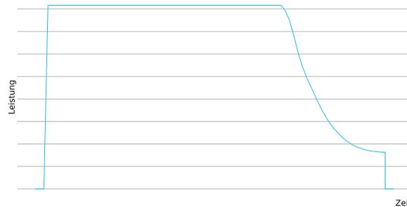
**Abbildung 3.12:** Schematisches Ladeprofil eines E-Kfz
